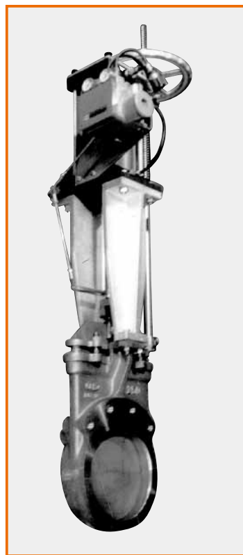
■ラウンドポートナイフゲートバルブ 手動兼エアシリンダー操作 電空ポジショナー式 S-1026
