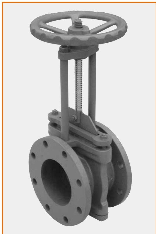
■71型ロング板弁 底フタ付 S-111 (固形物の詰まった場合の掃除口)
